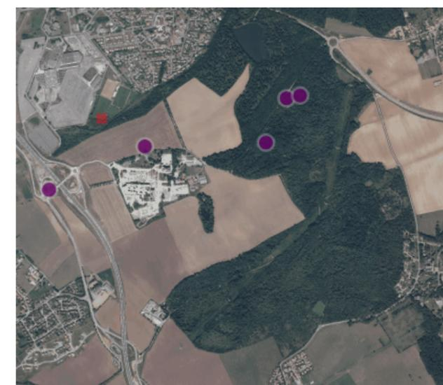
Figure 23: Mouvements de terrain (carré rouge) et cavités souterraines (rond violet) au droit de la zone d'étude (Source: BRGM)
